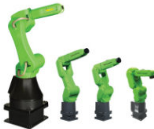
Roboty współpracujące FANUC serii CR Udźwig od 4 do 35 kg, zasięg od 550 do 1813 mm Certyfikat bezpieczeństwa TÜV ISO 10218-1:2011 (kategoria 3, PL=d)
